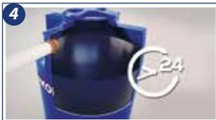
4. Encher a Cisterna Bakof antes de efetuar o aterramento, deixando-a em repouso por no mínimo 24h para assegurar que a estanqueidade tenha sido preservada durante a movimentação, instalação e conexões.
