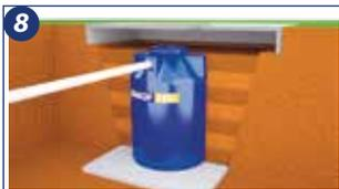
8. Caso a Cisterna Bakof esteja instalada em local de intensa circulação ou circulação de veículos, deve ser construída uma laje que não esteja apoiada no produto.
