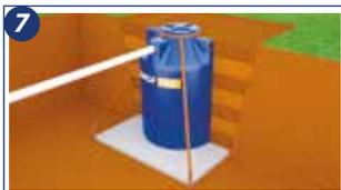
7. Em terrenos arenosos/mofoedicos/de lençol freático superficial, além de sapata, realizar a ancoragem da Cisterna Bakof.
