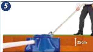
5. Utilizar terra peneirada (livre de pedras ou objetos pontiagudos), areia ou pó de brita adicionados a cimento ao traço 1:10 como aterramento e efetuar a compactação a cada 25 cm. O processo de aterramento não deve ser mecanizado. Aterro máximo de 30 cm sobre a tampa.
