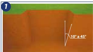
1. Escavar o local de instalação com paredes em inclinação de 10° a 45° e nivelar a terra na base (cuja dimensão deve ser 10 cm maior em cada lado que a base do produto).
